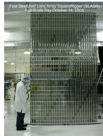
**Figure 1:** Full scale SLASR module
